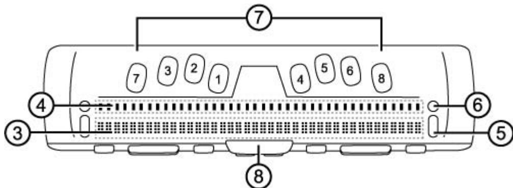
Brajeve ćelije (3) nalaze se na prednjoj strani uređaja. Dugme za postavljanje pokazivača (4) iznad svake Brajeve ćelije. Na svakom kraju radne površine displeja (Brajevog reda) nalaze se rockers dugmad (5) koji se koriste za brzo kretanje. Postavljen iznad svakog rocker dugmeta nalaze se režim (mode) dugmad (6) kojima se određuju različiti režimi kretanja.
